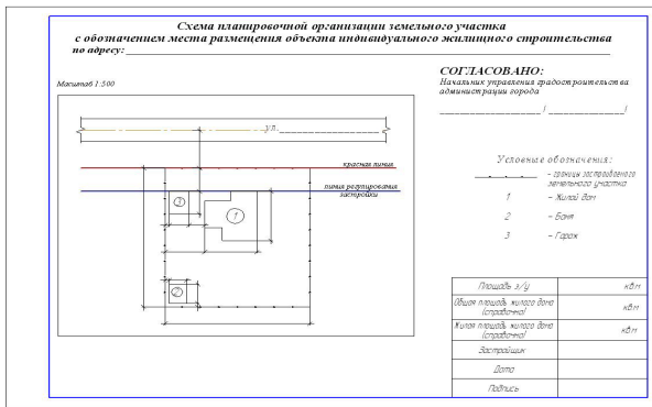
Образец схемы планировочной организации земельного участка с обозначением места размещения объекта индивидуального жилищного строительства
