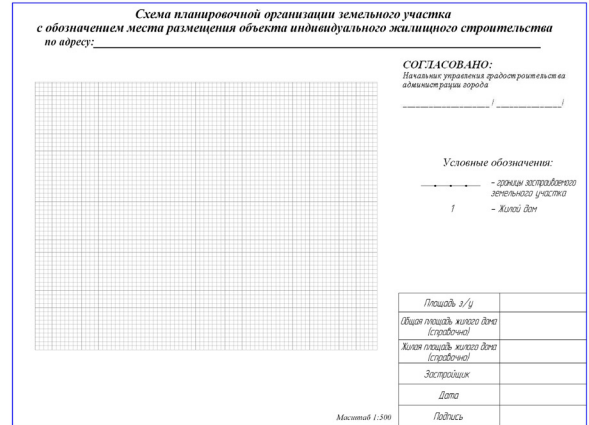
Шаблон схемы планировочной организации земельного участка с обозначением места размещения объекта индивидуального жилищного строительства
